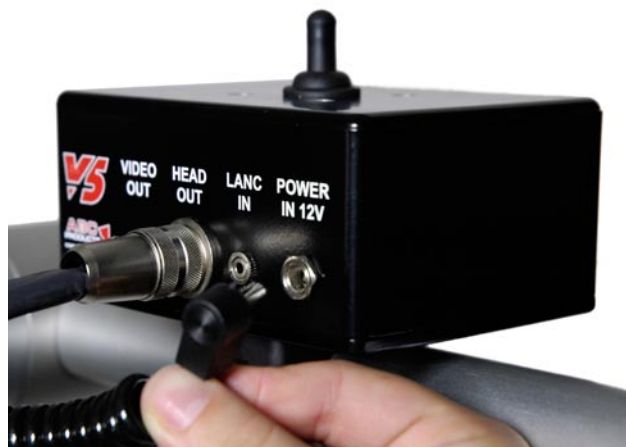
2. Steuerkabel am Steuerkasten anschließen
